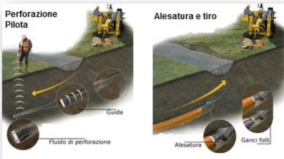
Figura 15 - Tecnologia di trivellazione orizzontale controllata (TOC)
