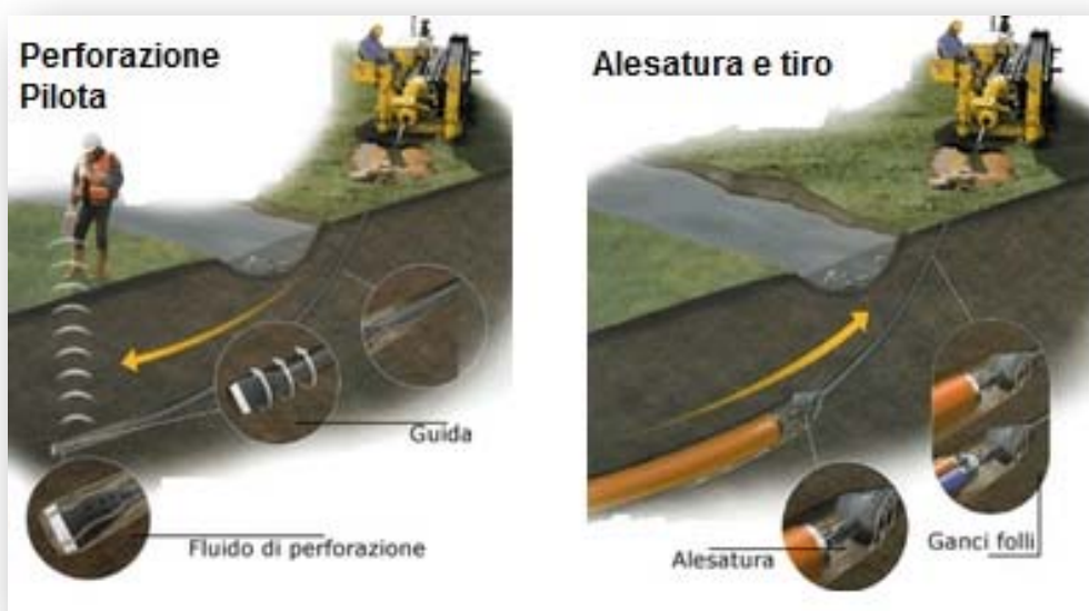
Figura 30 - tecnologia di trivellazione orizzontale controllata (TOC)
