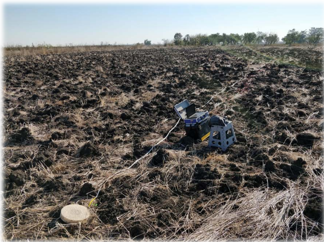
Stendimento sismico di tipo MASW M_1
