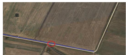
Figura 6-5- Dimensione trapezia tipo e ubicazione del fosso (linea blu) e del tombino
