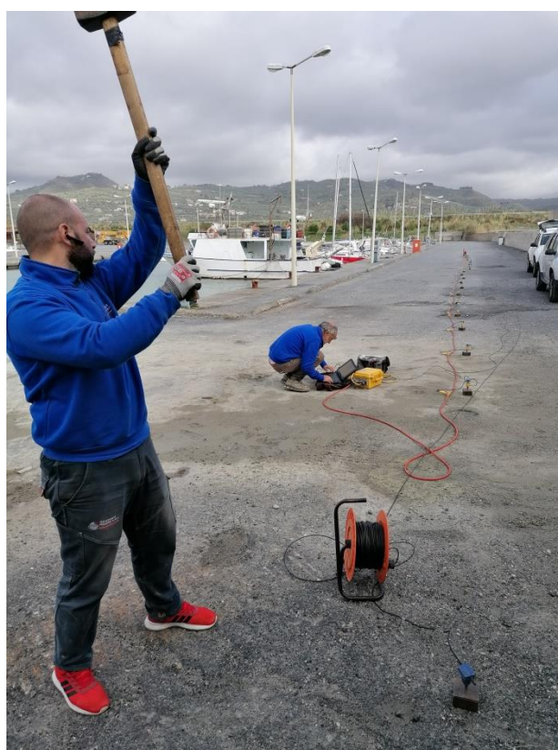
Foto 2 – Esecuzione della prospezione sismica con metodologia MASW.
