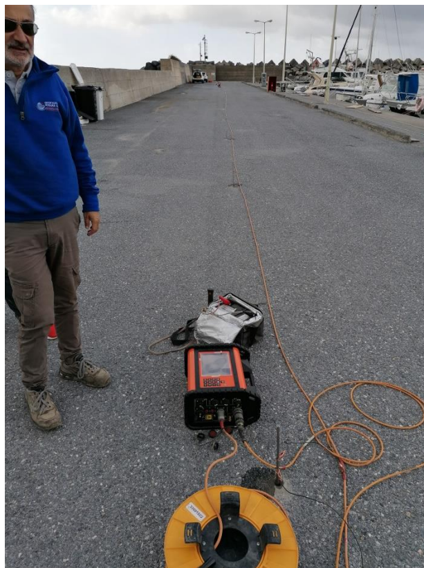
Foto 3 – Esecuzione della prospezione geoelettrica in configurazione multielettrodica.
