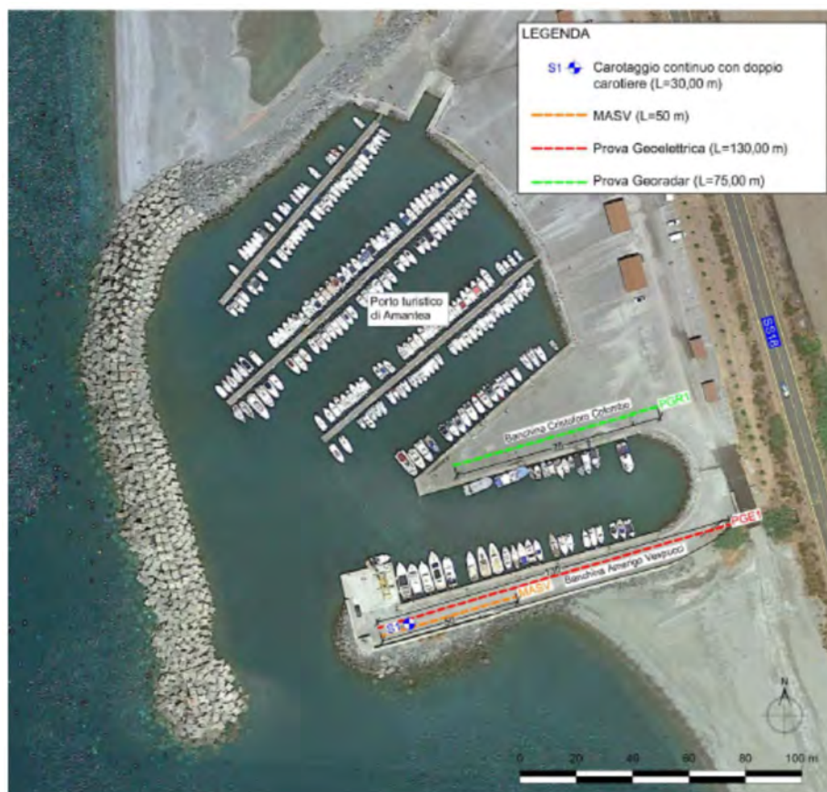
Figura 7 – Ortofoto del porto di Amantea con indicazione delle indagini eseguite.
