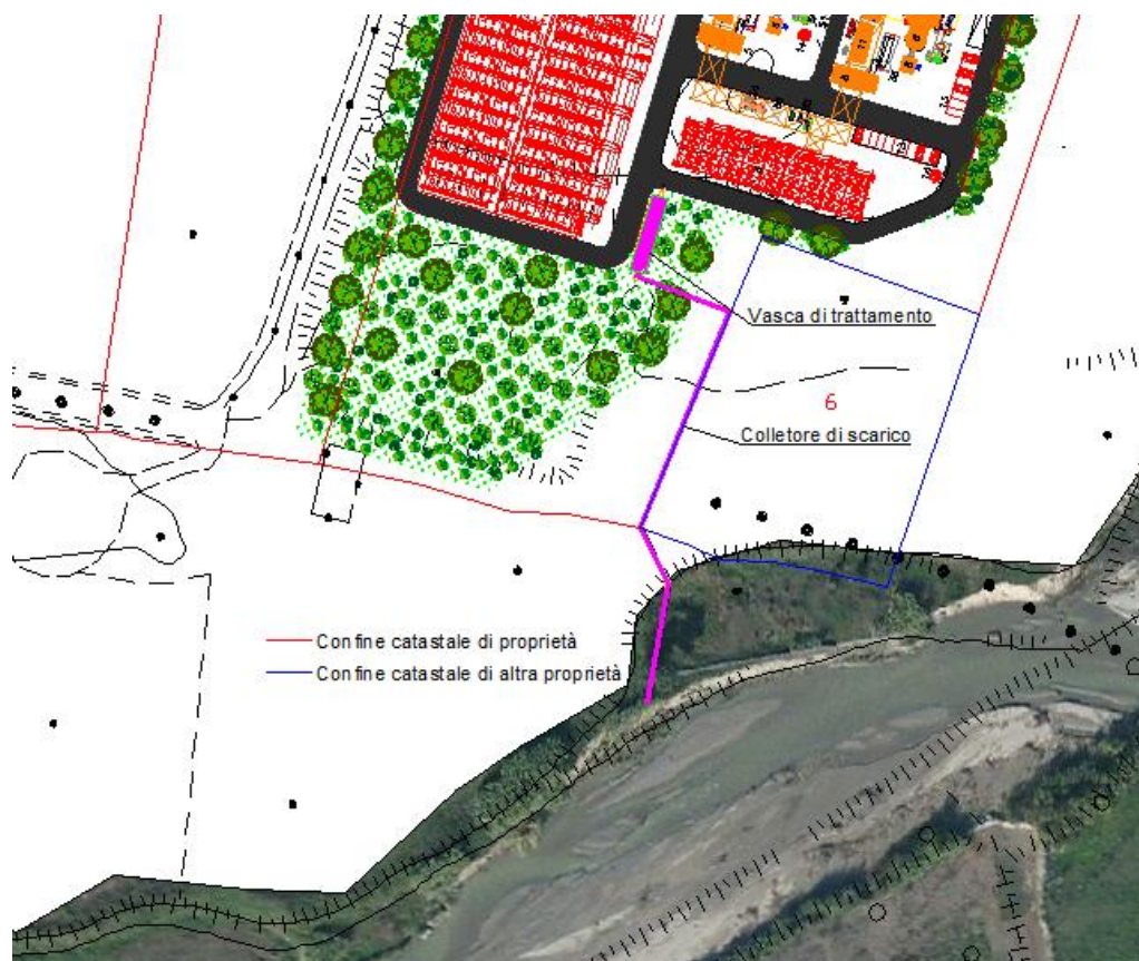
Figura 23: Vista planimetrica collettore di scarico
