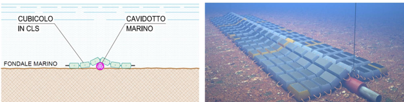
Figura 4.12 – Protezione del cavidotto marino mediante materassi in calcestruzzo.
