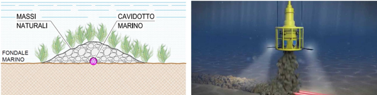
Figura 4.11 – Protezione del cavidotto marino mediante massi.
