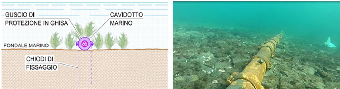
Figura 4.13 – Protezione del cavidotto marino mediante gusci in ghisa.
