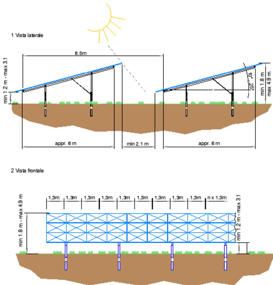
La profondità di interrimento dei pali di fondazioni varia in funzione della forma e delle condizioni di carico locali, e delle condizioni geologiche del sito
