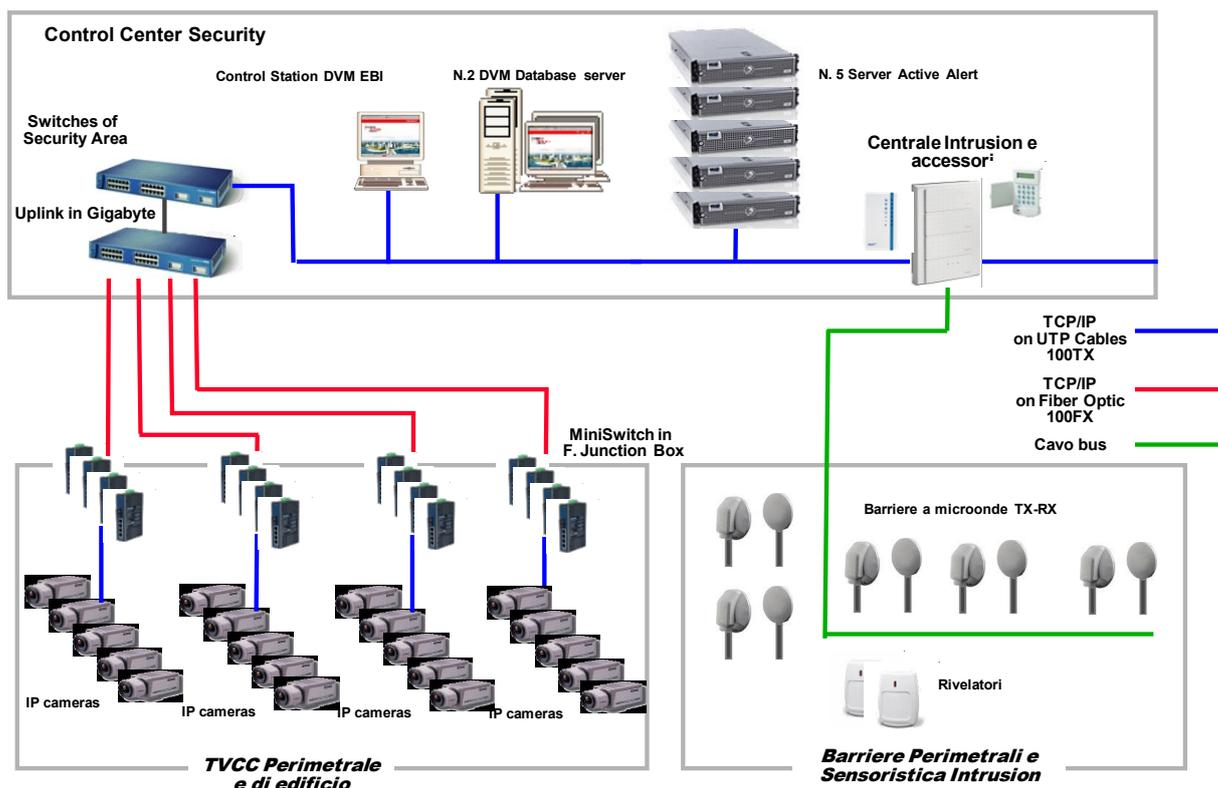
**Figura 5 – Schema del sistema di sorveglianza**
