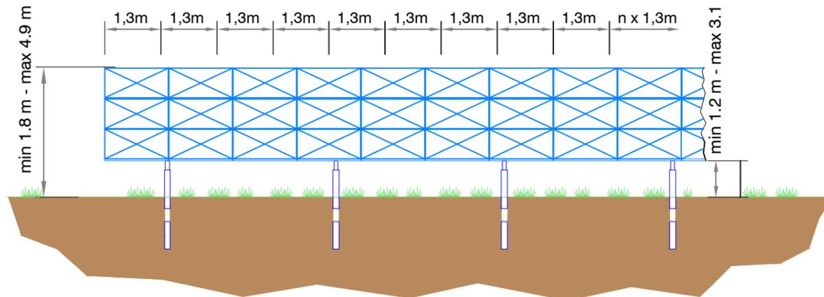
La profondità di interrimento dei pali di fondazioni varia in funzione della forma e delle condizioni di carico locali, e delle condizioni geologiche del sito
