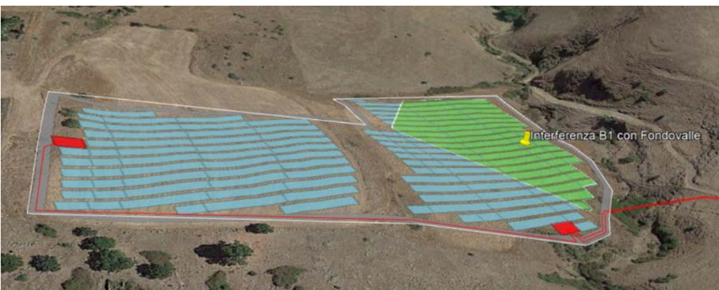
Fig. 3 – Layout impianto su Ortofoto storica 2016 porzione area B1 e sovrapposizione a shape PPTP con sfasamento di coordinate rispetto al reale territorio interessato dal fondovalle
