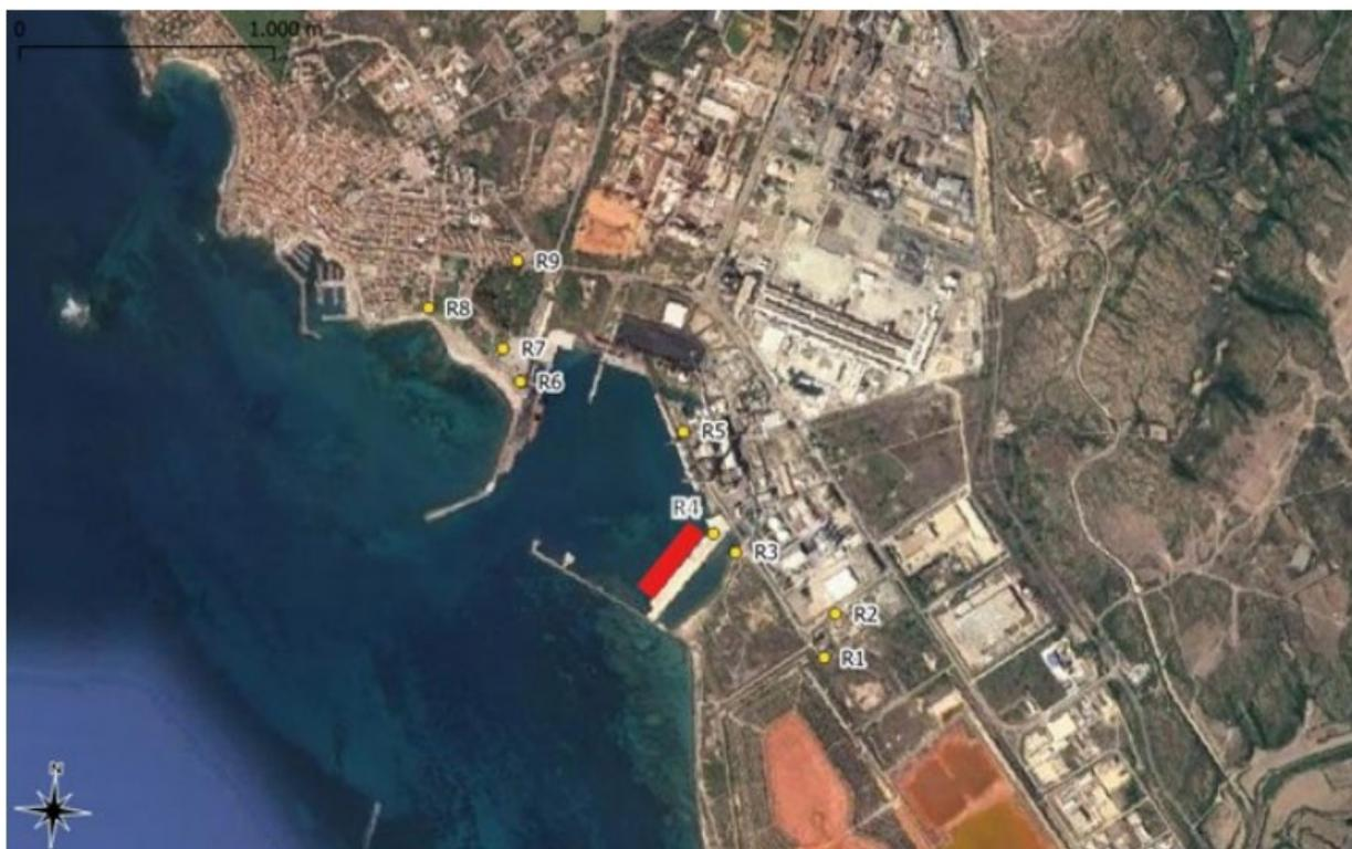
I rilievi acustici sono stati eseguiti presso tutti i ricettori con tecnica di campionamento (2 misure diurne da 20 minuti e una misura notturna da 20 minuti), da tecnici competenti in acustica, secondo le modalità previste dal decreto del 16 marzo 1998 "Tecniche di rilevamento e di misurazione dell'inquinamento acustico" ed hanno rilevato i seguenti parametri acustici: spettro sonoro, livello di rumore ed eventuali componenti tonali e impulsive.
