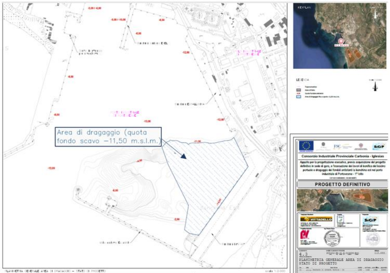
Figura 6-8: Progetto di Dragaggio dei Fondali Antistanti la Banchina Est nel Porto Industriale di Portovesme
