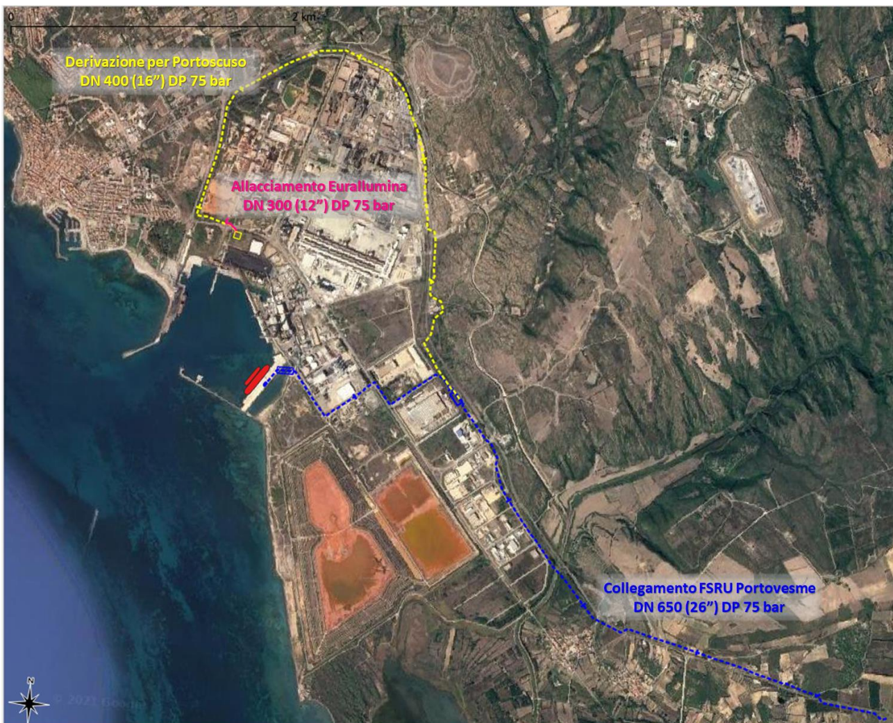
Figura 1-3: Schema della Rete Energetica di Portovesme
