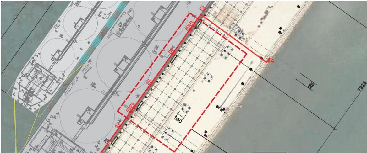
**Figura 2-7: Layout dei plinti del sistema di rinforzo fender**
