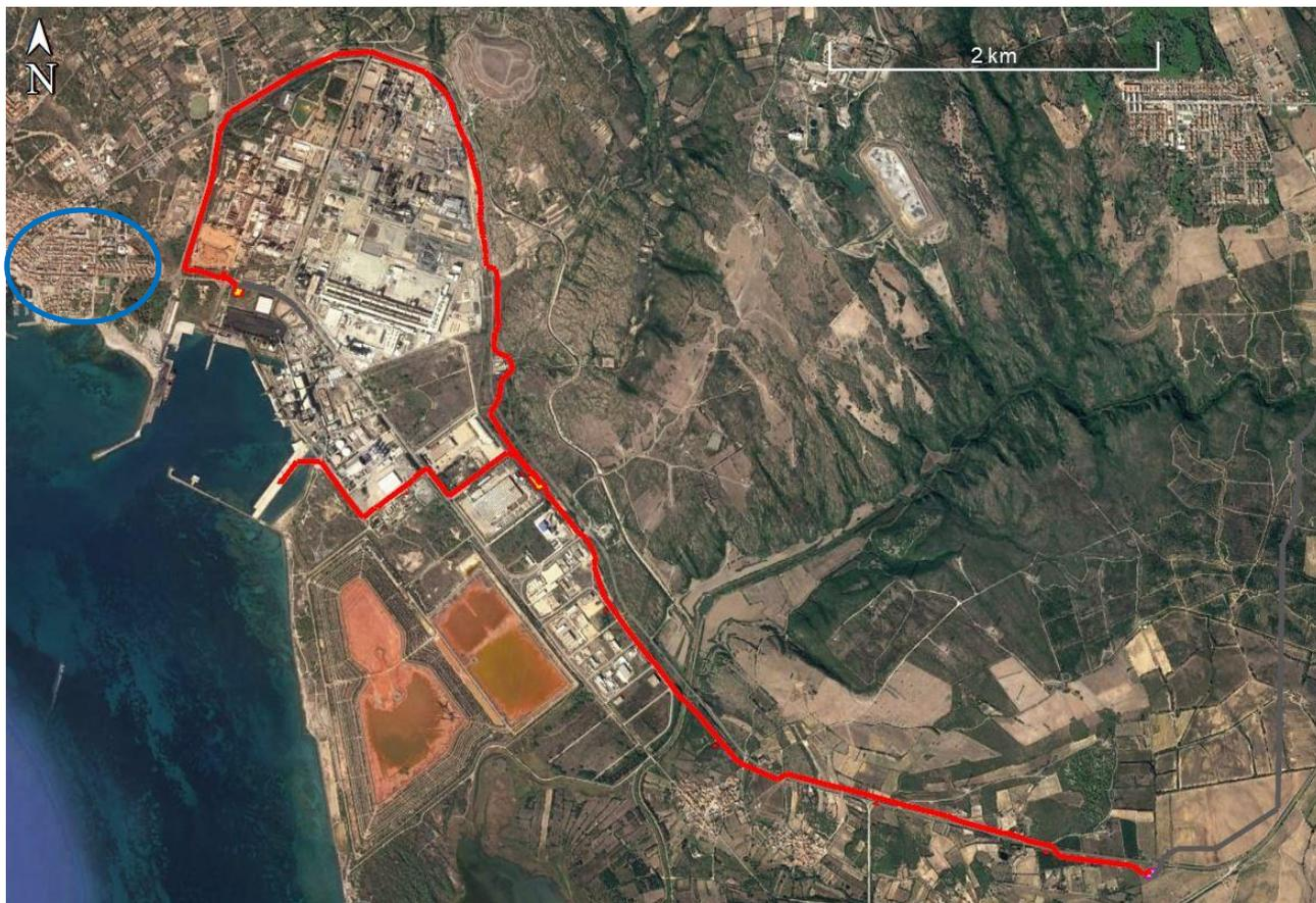
**Figura 5.9.3/A: Abitato di Portoscuso in blu e in rosso metanodotto Derivazione per Portoscuso DN 400 (16”), DP 75 bar**
