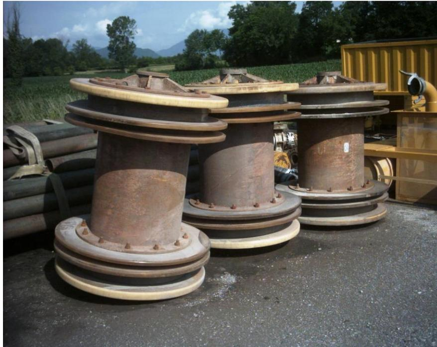
**Figura 3.3.7.1/B: Pig per collaudo idraulico**
