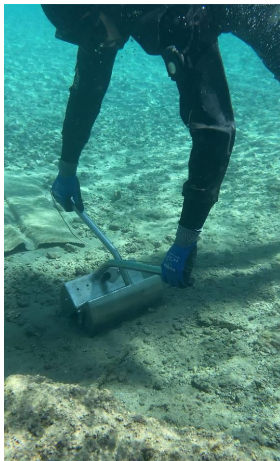
Fig.4 Immagine del campionamento nel punto AIM01 dalla superficie e con l'utilizzo della benna di Van Veen
