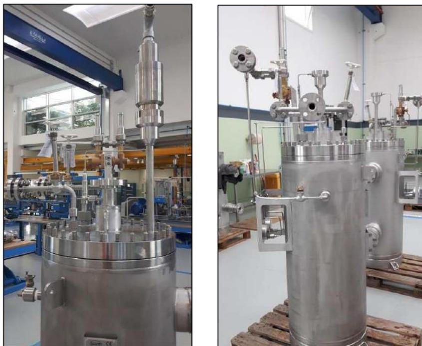
**Figura 20** - Particolare assemblamento criostato
