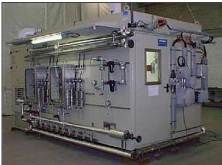
**Figura 30** - Skid Sistema di analisi – Cabina cromatografi
