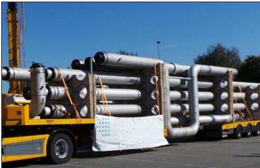
Figura 22 - Loops di espansione per le tubazioni VIP
