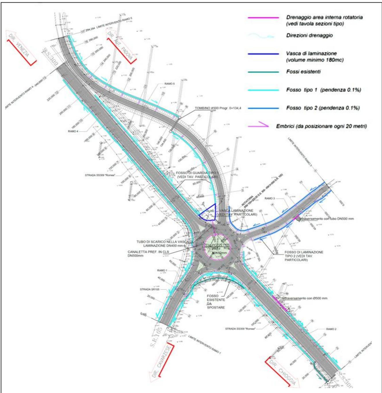
Fig. 5 – Planimetria del progetto idraulico
