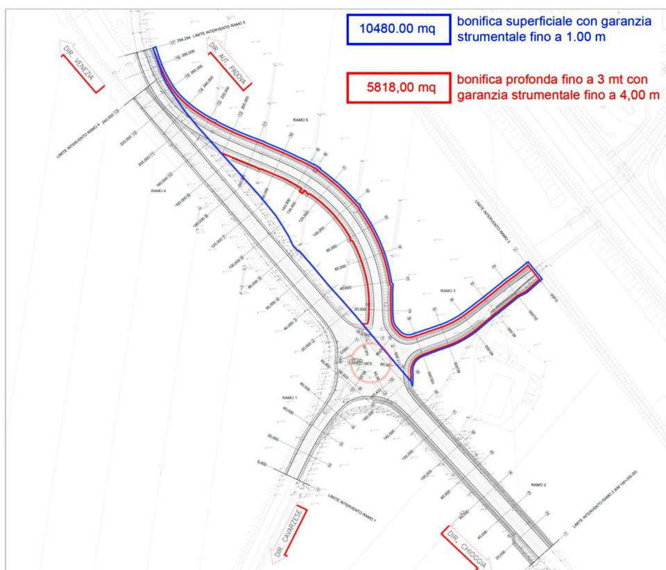
Figura 8 - Planimetria di Bonifica Ordigni Bellici
