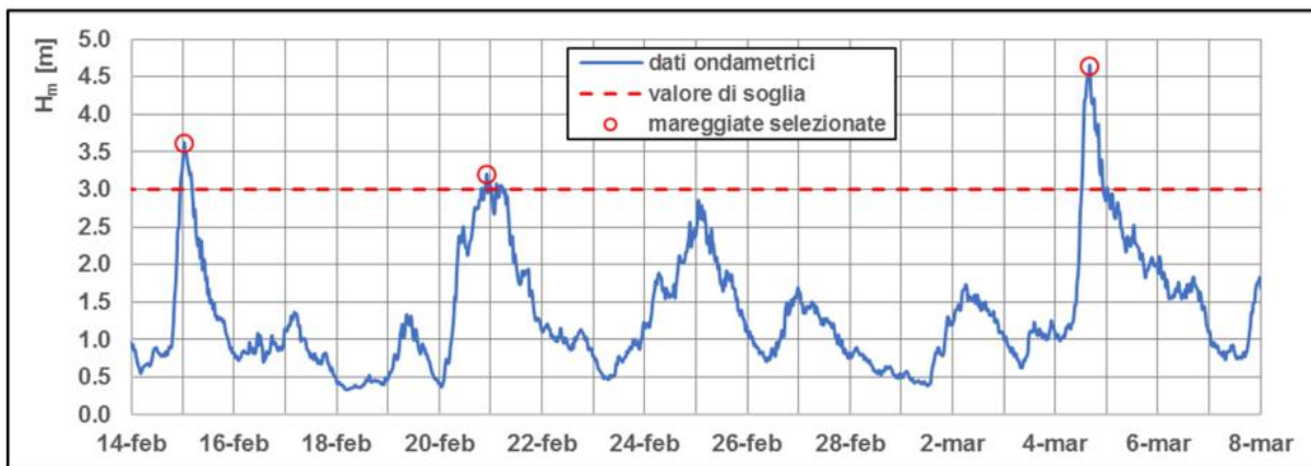
Figura 7-11: Esempio di sequenza di dati ondametrici per selezione delle mareggiate con metodo POT
