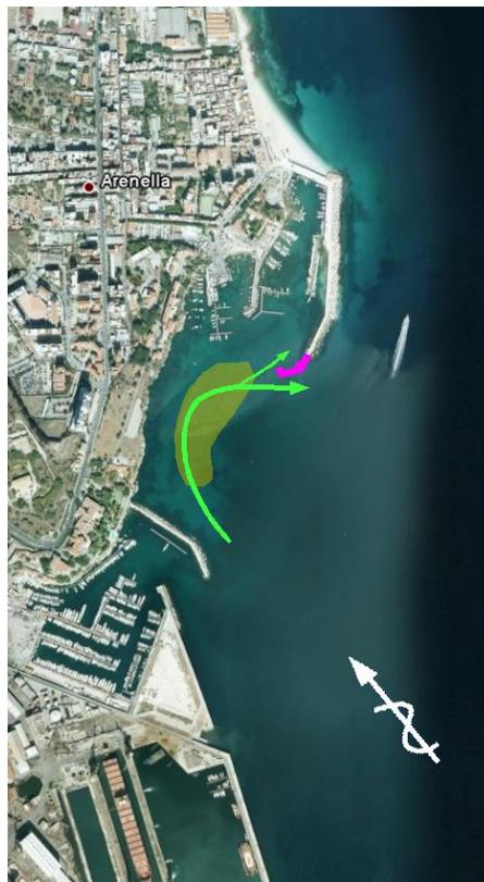
Figura 8-1: Mitigazione dell'interrimento del bacino di Arenella grazie al completamento del sopraflutto
