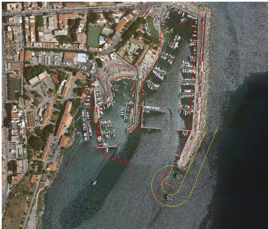
Figura 11: Localizzazione dei sondaggi geostatici
