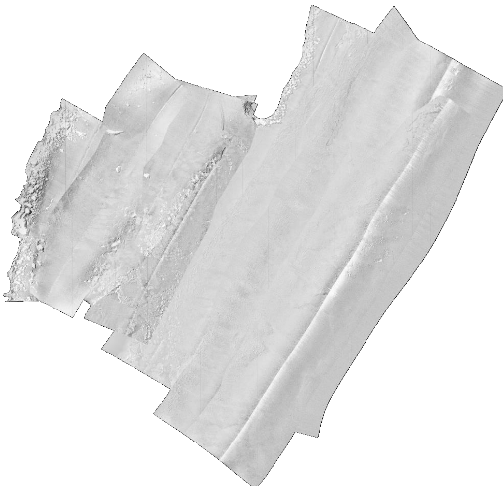
Figura 28. Mosaico acustico Side ScanSonar ottenuto dalla fusione delle singole strisciate
