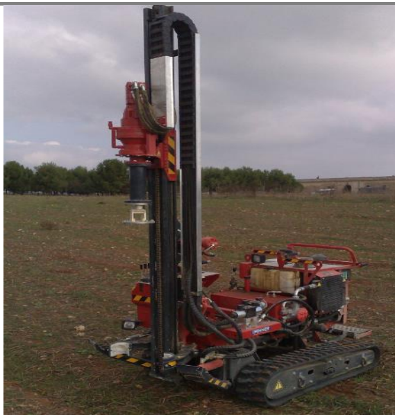
FIGURA 8 - MACCHINA BATTIPALO PER INFIESSIONE PALI.
