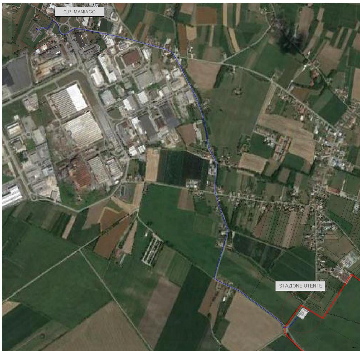
Tracciato cavidotto AT 132 kV su ortofoto
