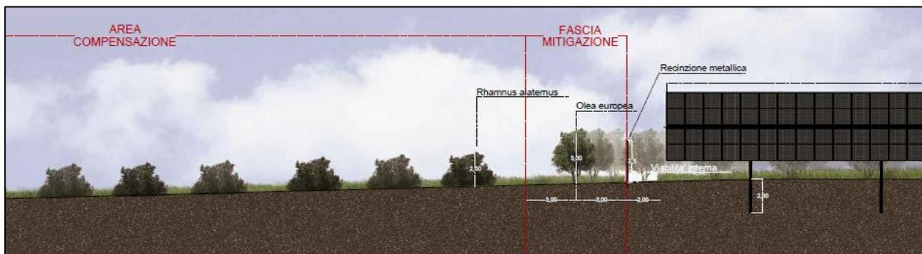
**Figura 4:** sezione dell'area di compensazione, fascia di compensazione e area di impianto.
