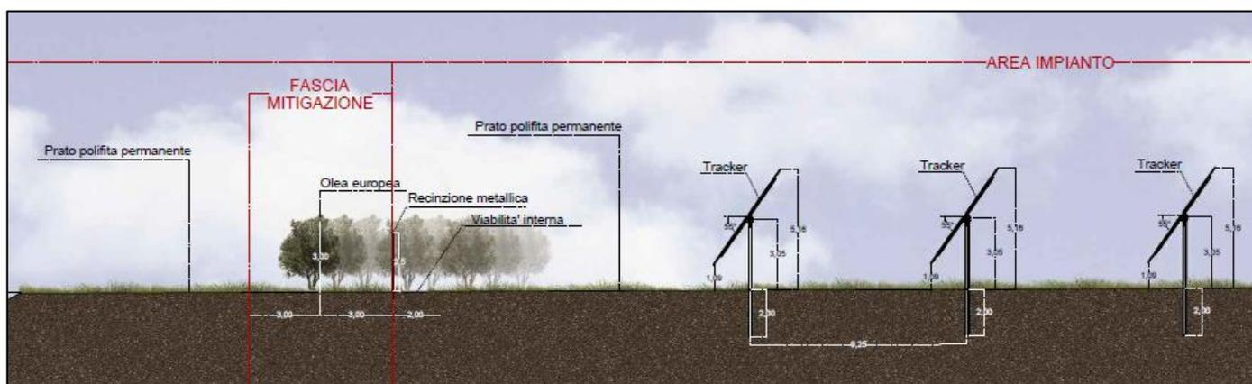
Figura 3: sezione della fascia di mitigazione e dell'area di impianto.
