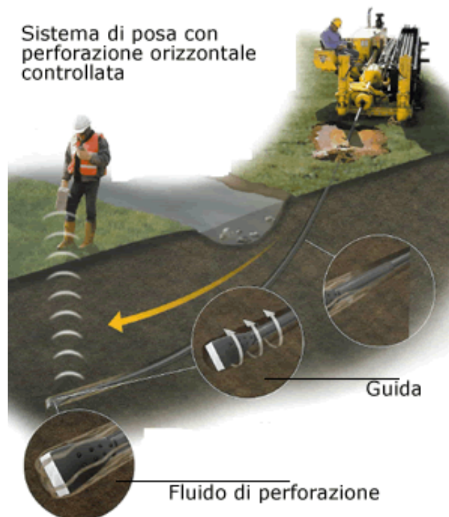
Figura 10 – Sistema di trivellazione orizzontale controllata (T.O.C.).
