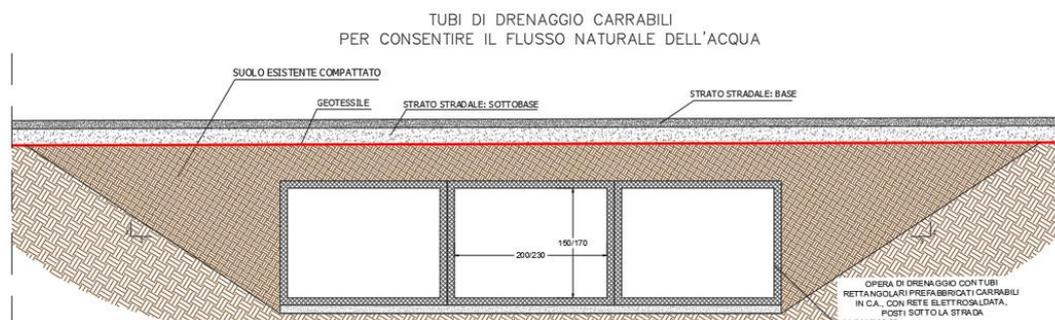
**Figura 57 Attraversamenti tipo con tubi a sezione rettangolare, sotto le strade interne d'impianto**
