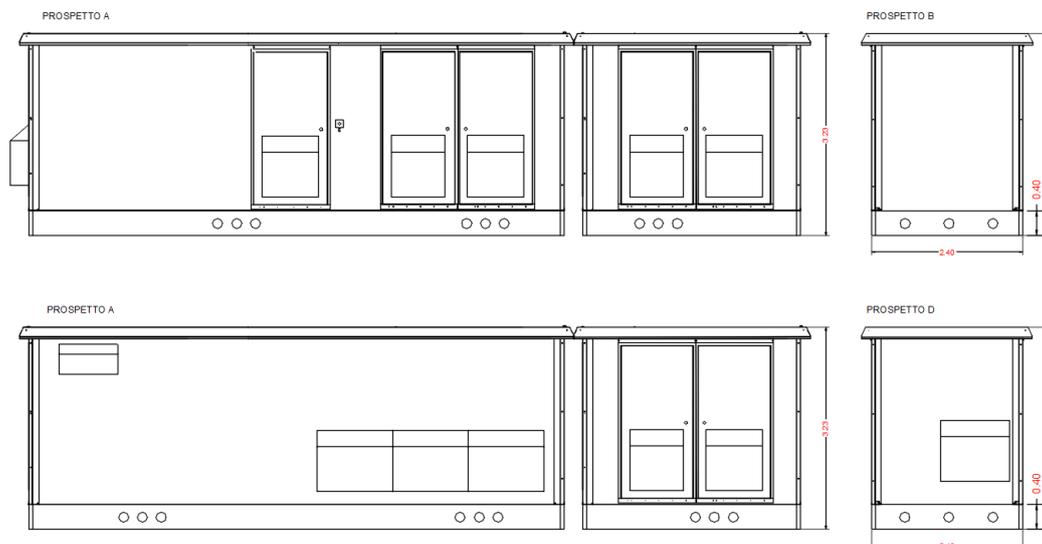
**Figura 53 Prospetti frontale e posteriore della cabinati di conversione con tipologia di fondazione a vasca**
