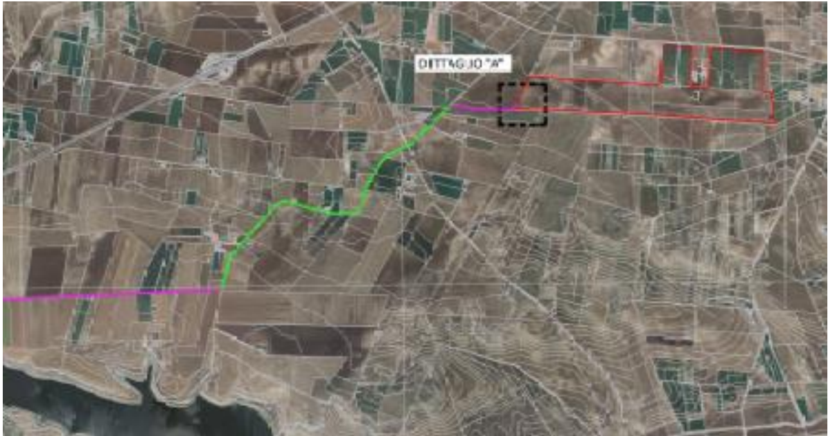
Figura 1 - Inquadramento dell'area di impianto su ortofoto (in rosso) con indicazione dei tratti di connessione (in verde se in suolo asfaltato/strada e in rosa se in terreno)
