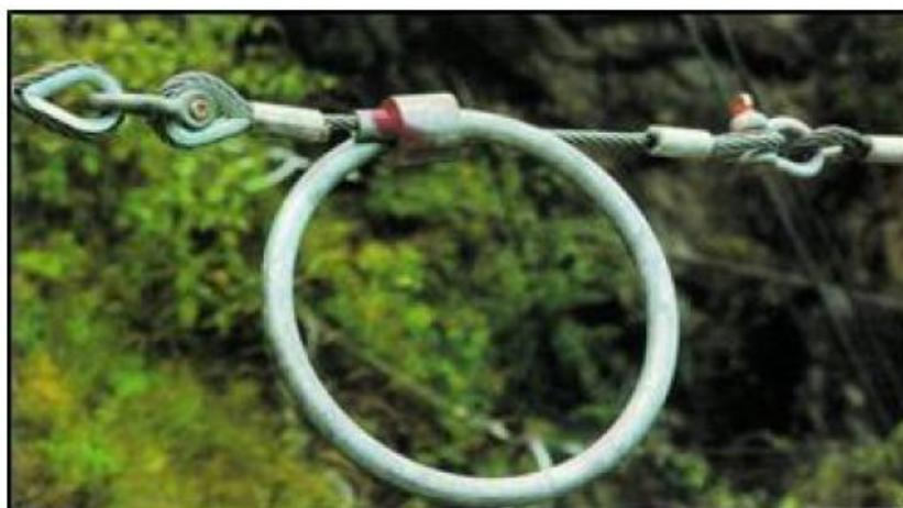
*Figura 5.9: Particolare di dissipatore di energia ad anello*
