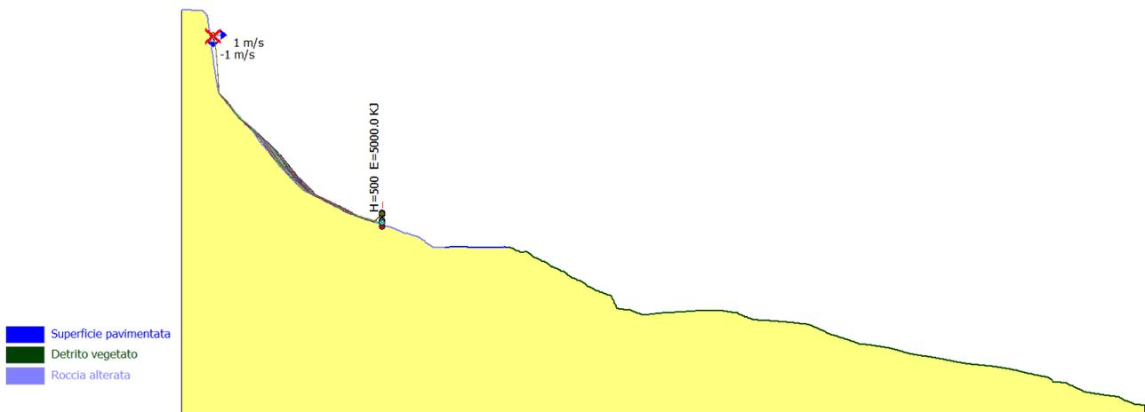
Figura 5.6: Sezione 13 - Traiettorie dei massi di progetto
