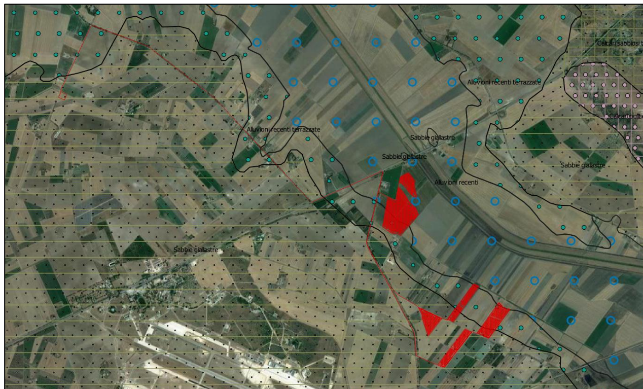
Figura 5: carta litologica dell'area (tematismi ricavati dalla Carta Geologica d'Italia in scala 1:50.000 del progetto CARG); i terreni presenti sono tutti di natura alluvionale, ma appartengono a differenti formazioni e presentano granulometria eterogenea.
