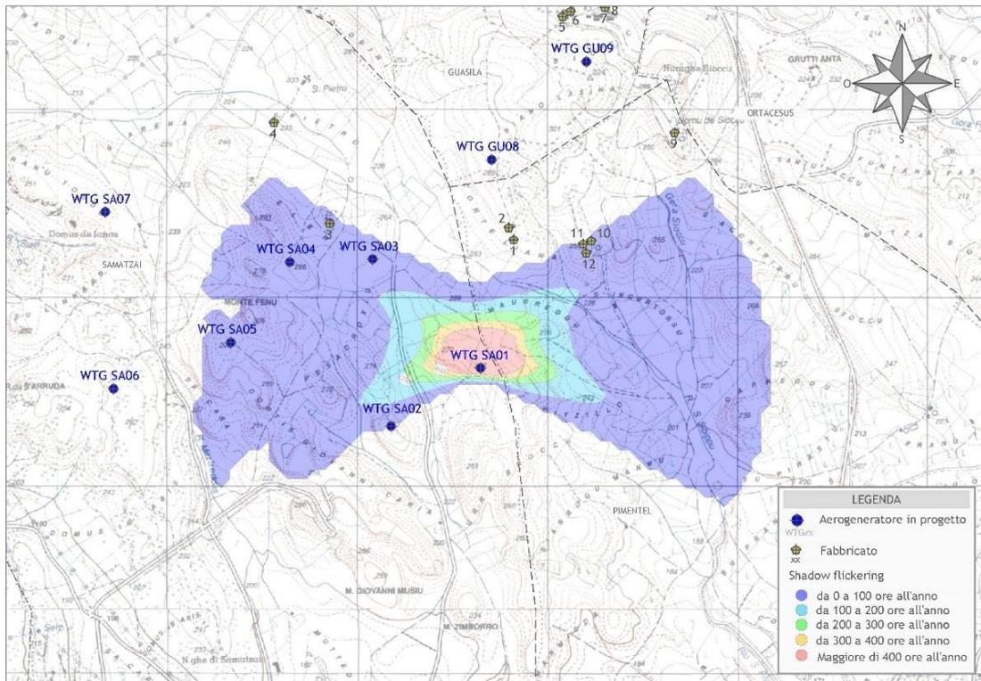
Figura 2 - Mappa di impatto potenziale per l'aerogeneratore WTG SA01
