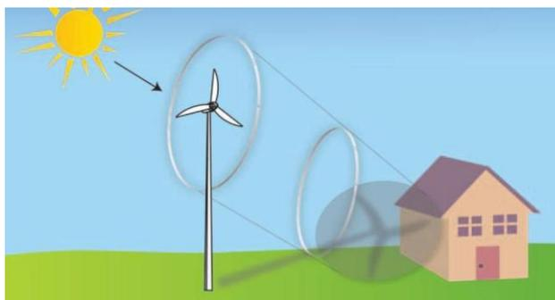
Figura 1 - Rappresentazione schematica del fenomeno dello shadow flicker
