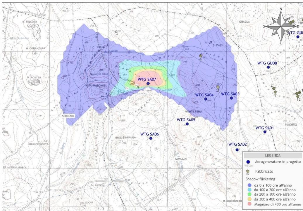
Figura 8 - Mappa di impatto potenziale per l'aerogeneratore WTG SA07
