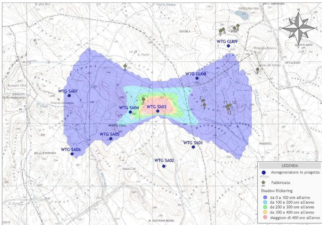
Figura 4 - Mappa di impatto potenziale per l'aerogeneratore WTG SA03
