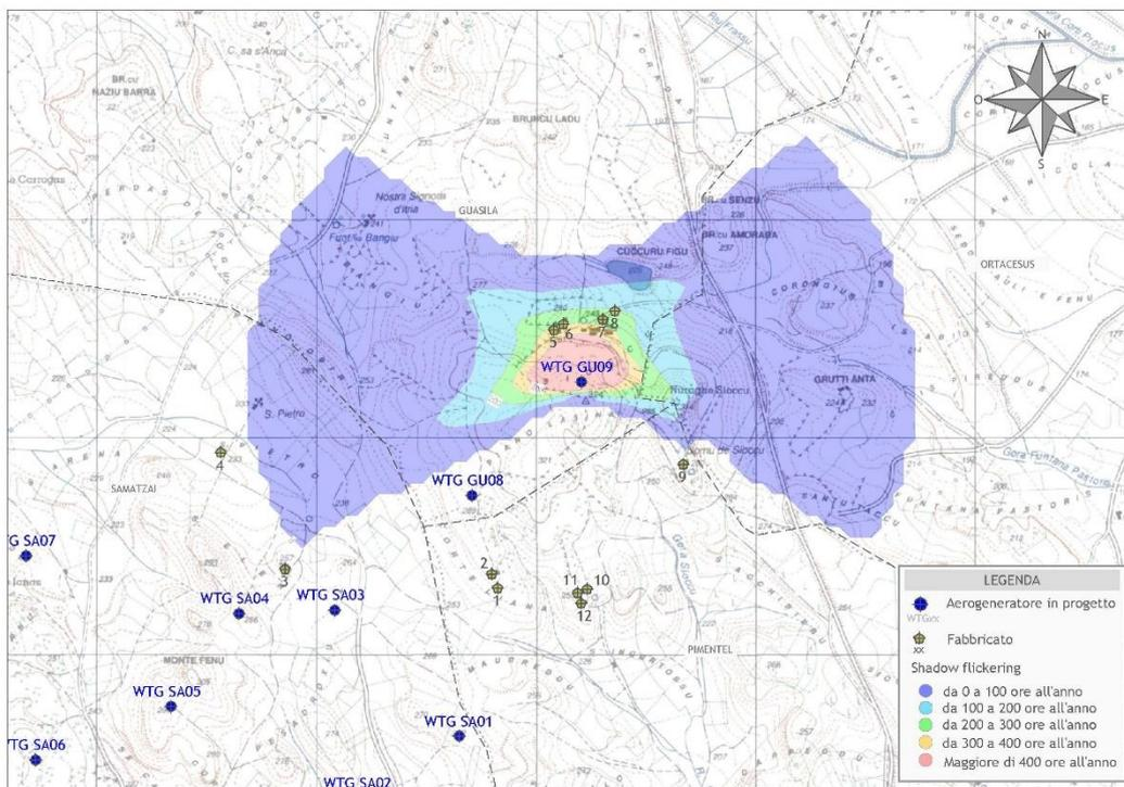
Figura 10 - Mappa di impatto potenziale per l'aerogeneratore WTG GU09
