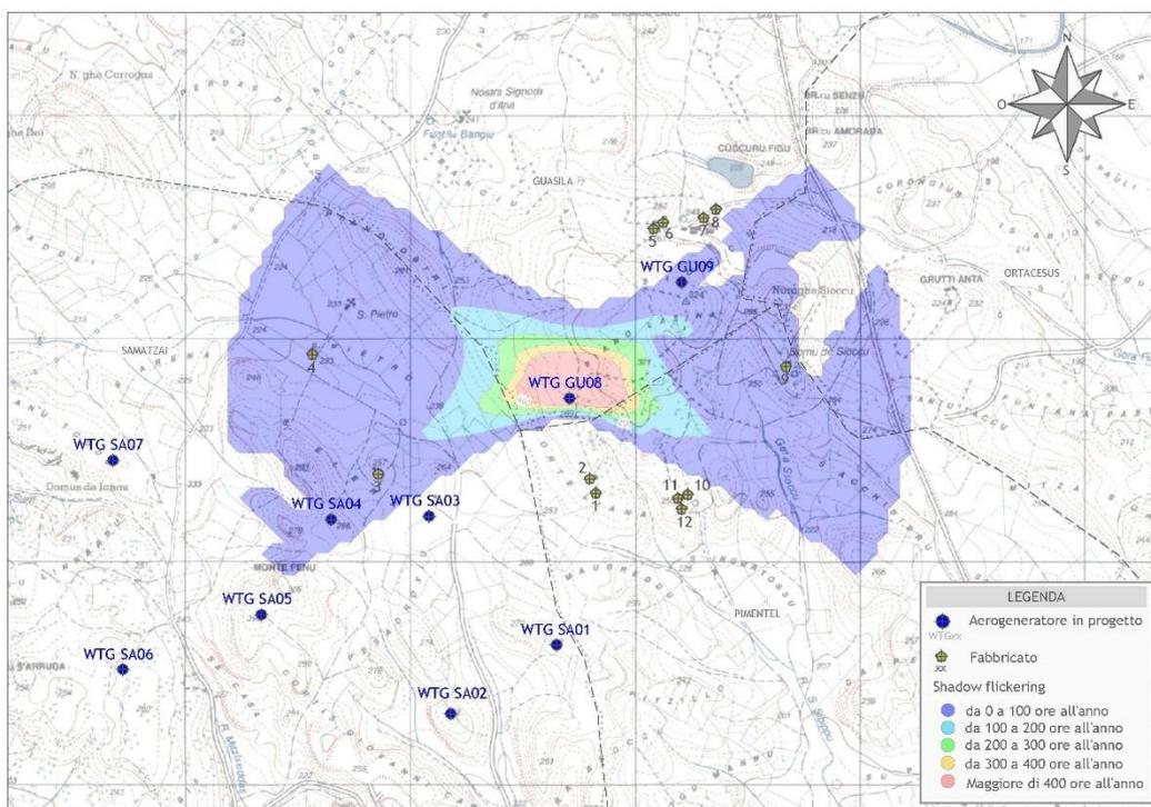
Figura 9 - Mappa di impatto potenziale per l'aerogeneratore WTG GU08
