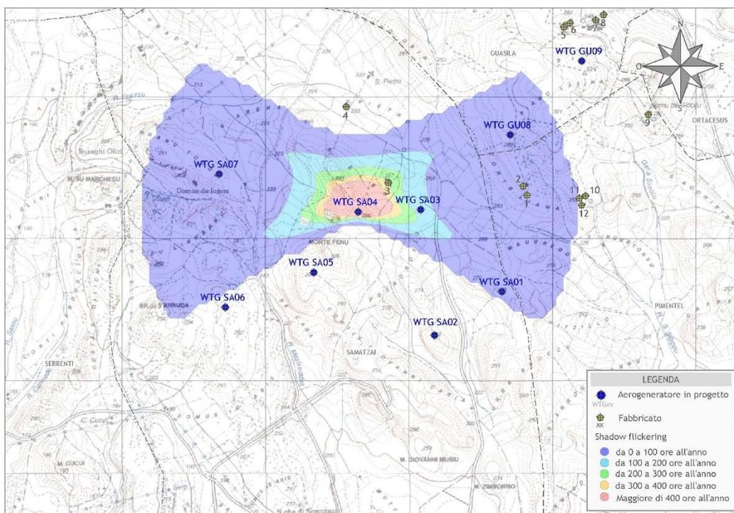
Figura 5 - Mappa di impatto potenziale per l'aerogeneratore WTG SA04
