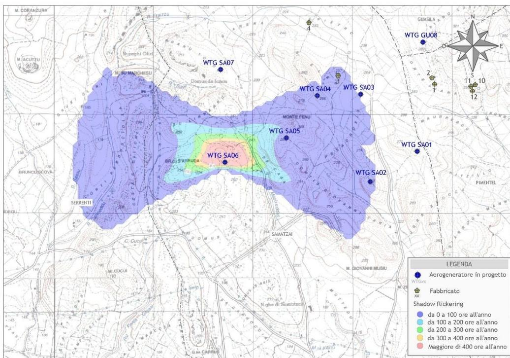
Figura 7 - Mappa di impatto potenziale per l'aerogeneratore WTG SA06
