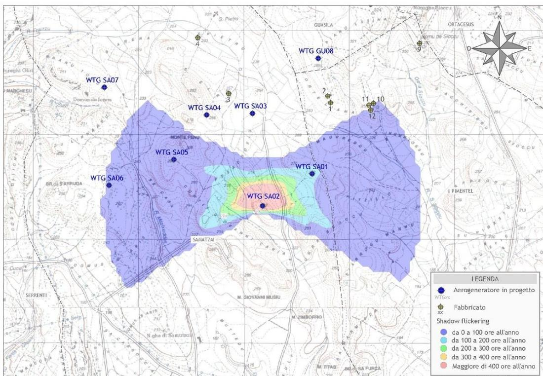
Figura 3 - Mappa di impatto potenziale per l'aerogeneratore WTG SA02
