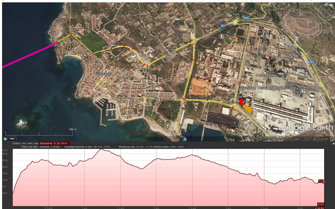
Figura 41 Profilo di Elevazione del terreno lungo il tracciato a terra (dati: Google Earth)
