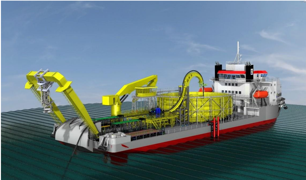
Figura 25 Esempio di nave posa cavo
