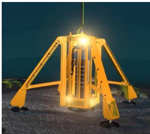
Figura 5-6 – Esempio di palo infisso nel fondale marino
