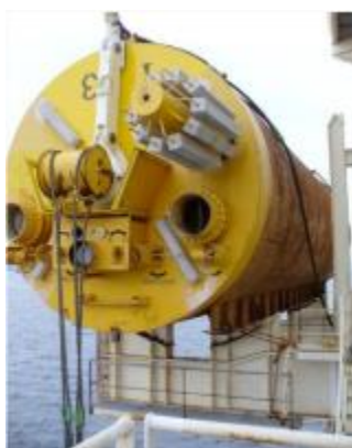
Figura 5-7 – Illustrazione di palo infisso per aspirazione
