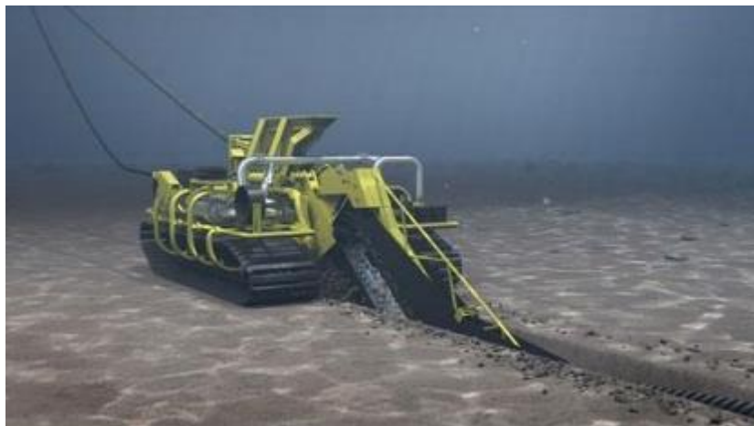
Figura 5-14 – Sistemi protezione dei cavi per interramento
