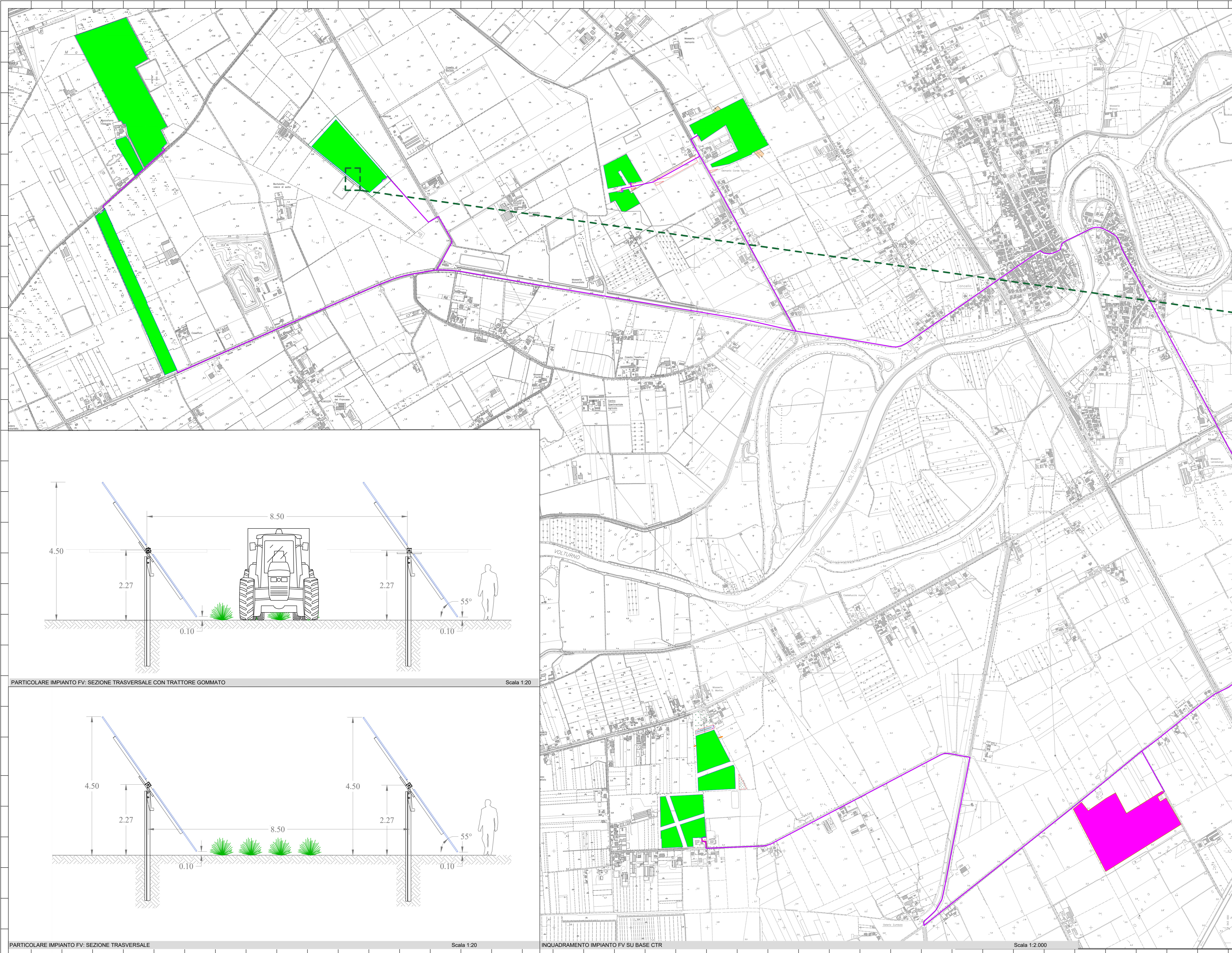
PARTICOLARE IMPIANTO FV: SEZIONE TRASVERSALE Scala 1:20
