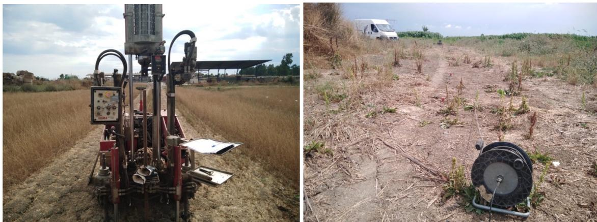
Figura 9: CPT 1 e Masw nell'ara di futura realizzazione stazione elettrica
