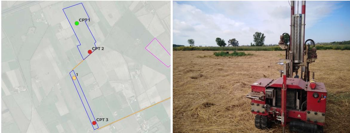
Figura 6: Prova Penetrometrica CPT1 eseguita in prossimità della stazione elettrica
