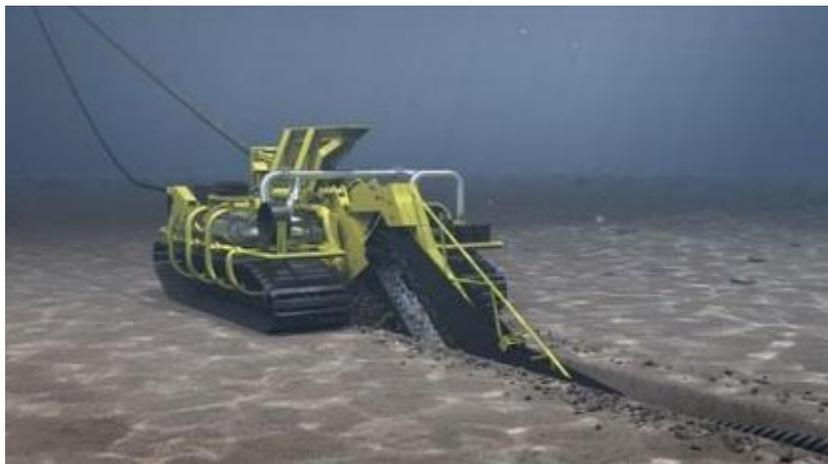
Figura 5-15 – Sistemi protezione dei cavi per interramento
