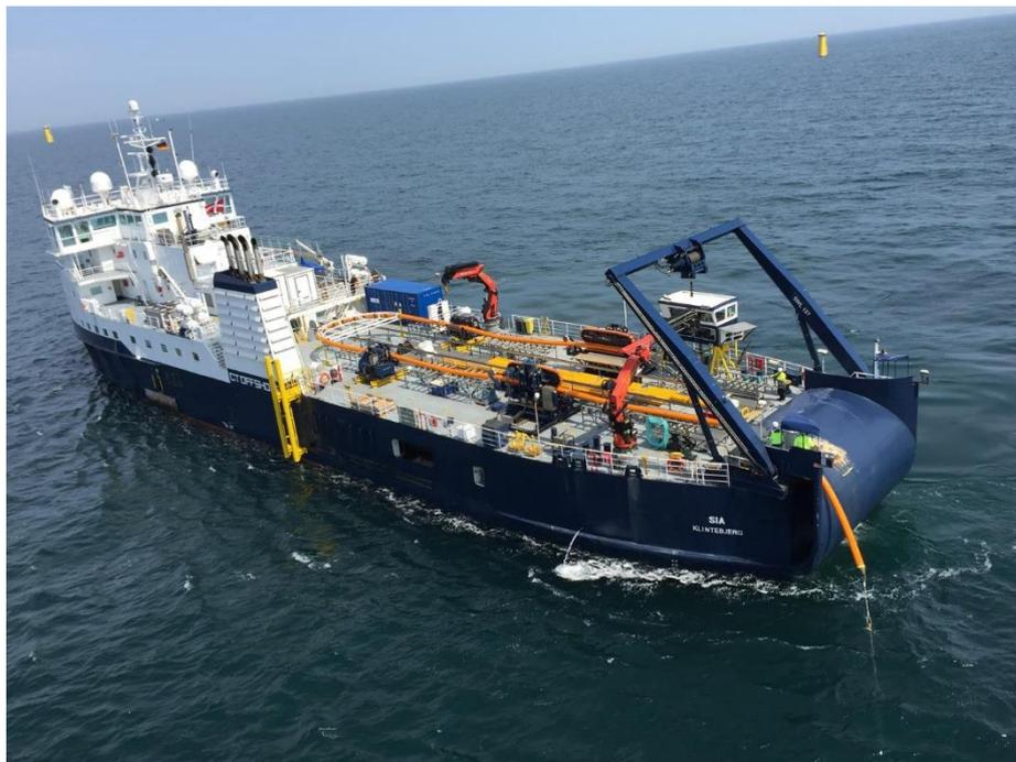
Figura 6-8 – Illustrazione dell'installazione del cavo (Fonte: Offshore Gode-wind)
