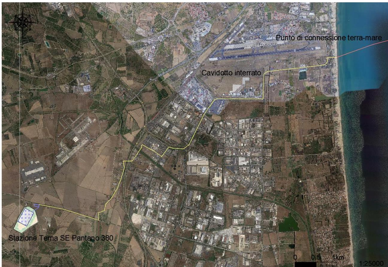
Figura 5-20 – Vista aerea del percorso del cavo di terra
