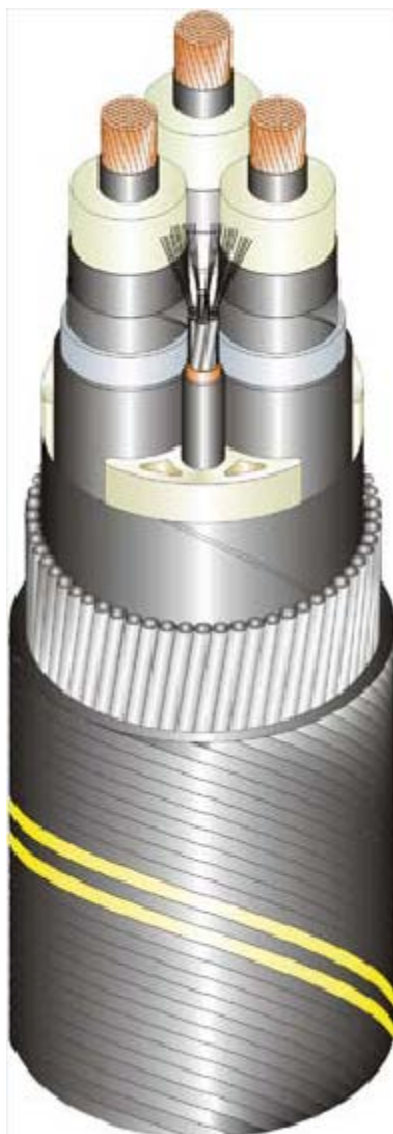
Fig. 3-1: sezione tipica del cavo marino XLPE tripolare in rame, con schermi in piombo, armatura in acciaio e fibra ottica
