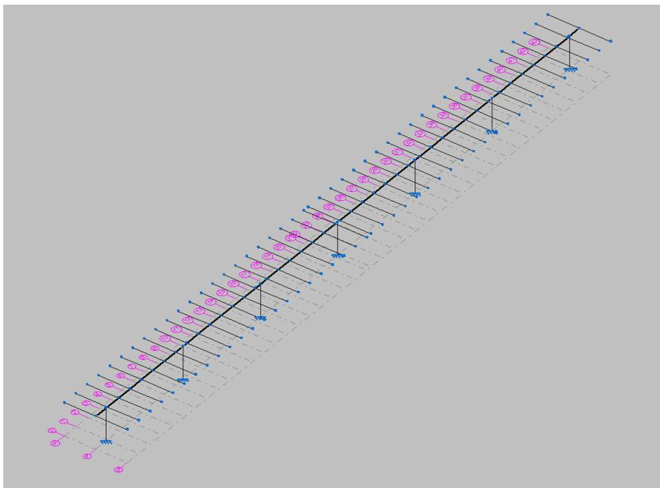
Il dimensionamento è stato condotto applicando tre combinazioni di carico, una per massimizzare l'effetto delle sollecitazioni di compressione e momento sull'opera di fondazione e due per massimizzano le sollecitazioni di trazione.
