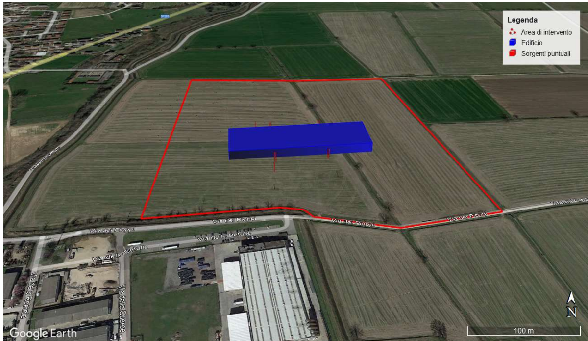
Figura 7-2 – Rappresentazione tridimensionale delle sorgenti simulate (in rosso) e dell'edificio di progetto considerato per calcolare l'effetto di Building Downwash (in blu)
