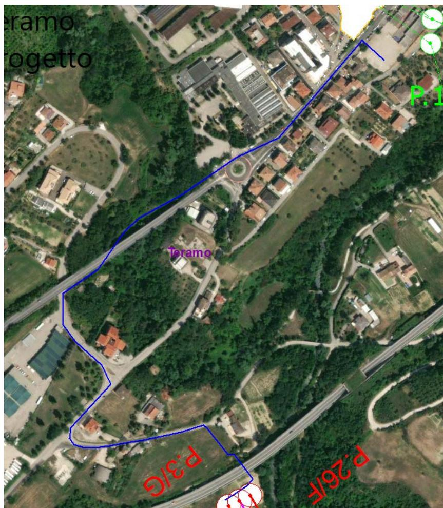
**Figura 4: tracciato cavidotto interrato su viabilità esistente**
