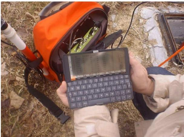
Sono stati acquisiti in un primo tempo una serie di vertici di poligonale, collegati ai capisaldi di impiantazione stabiliti, posti, con rilievo GPS statico per periodi mai inferiori ai 30 minuti, in modo tale da creare triangolazioni GPS in fase di rilievo e da rendere visibili due vertici da ogni vertice.
