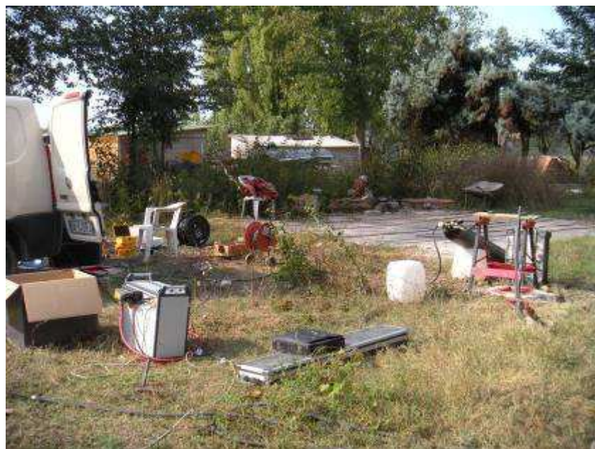
Figura 2.2 – Operazioni di acquisizione dati del carotaggio sismico CH eseguito sulla coppia di fori BH 219 e CH 219 (Finale Emilia).
