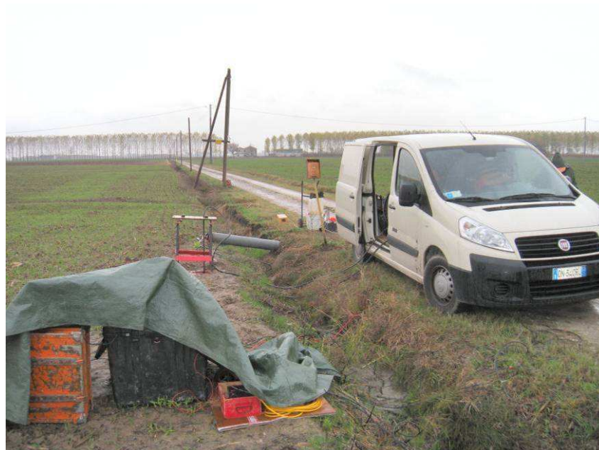
Figura 2.3 – Operazioni di acquisizione dati del carotaggio sismico CH eseguito sulla coppia di fori BH 229 e CH 229 (località Finale Emilia).
