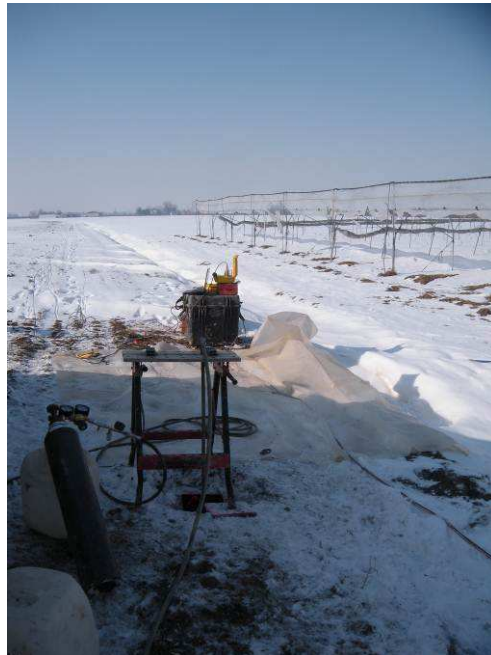
Figura 2.5 – Operazioni di acquisizione dati del carotaggio sismico CH eseguito sulla coppia di fori BH 210 e CH 210 (località San Felice sul Panaro)
