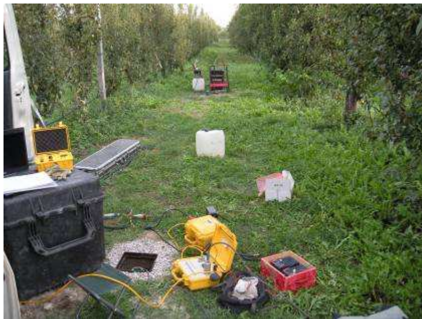
Figura 2.1 – Operazioni di acquisizione dati del carotaggio sismico CH eseguito sulla coppia di fori BH 202 e CH 202 (località San Felice sul Panaro).
