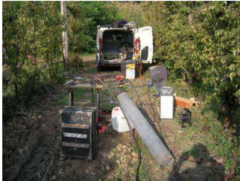
Figura 2.3 – Operazioni di acquisizione dati del carotaggio sismico CH eseguito sulla coppia di fori BH 229 e CH 229 (località Finale Emilia).
