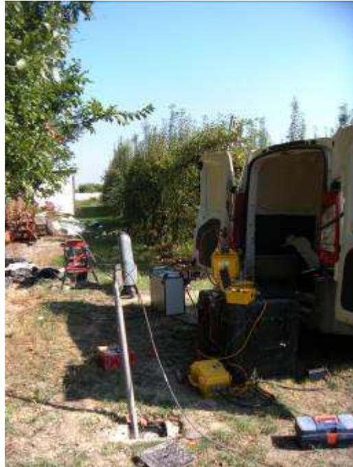
Figura 2.3 – Operazioni di acquisizione dati del carotaggio sismico CH eseguito sulla coppia di fori BH 442 e CH 442 (località Poggio Renatico).
