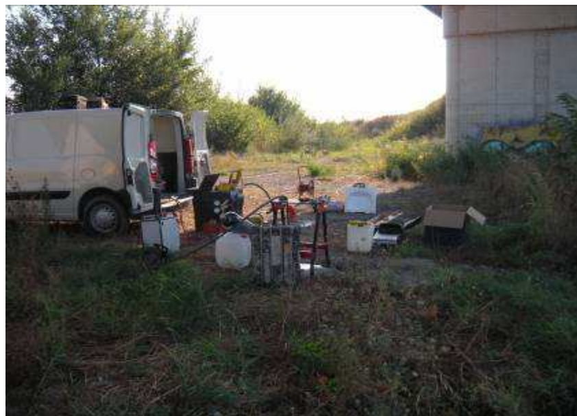
Figura 2.1 – Operazioni di acquisizione dati del carotaggio sismico CH eseguito sulla coppia di fori BH 407 e CH 407 (località Poggio Renatico).
