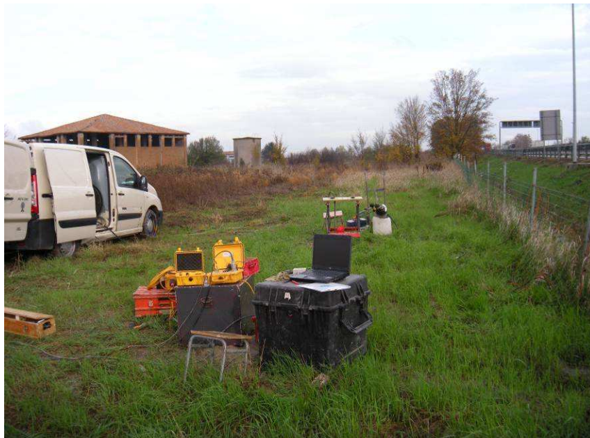
Figura 2.4 – Operazioni di acquisizione dati del carotaggio sismico CH eseguito sulla coppia di fori BH 433 e CH 433 (località Poggio Renatico).
