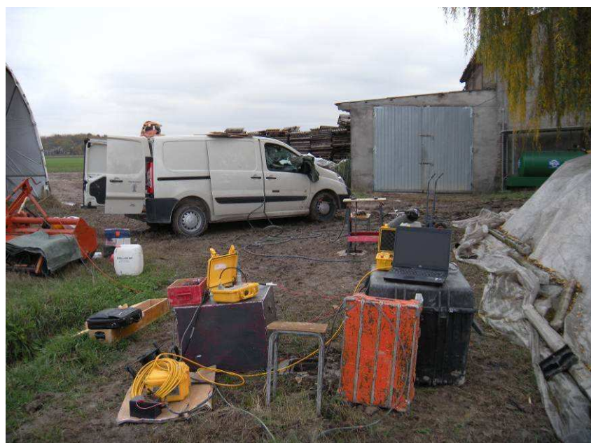
Figura 2.6 – Operazioni di acquisizione dati del carotaggio sismico CH eseguito sulla coppia di fori 1FEBH12 e 1FECH12 (località Bondeno).
