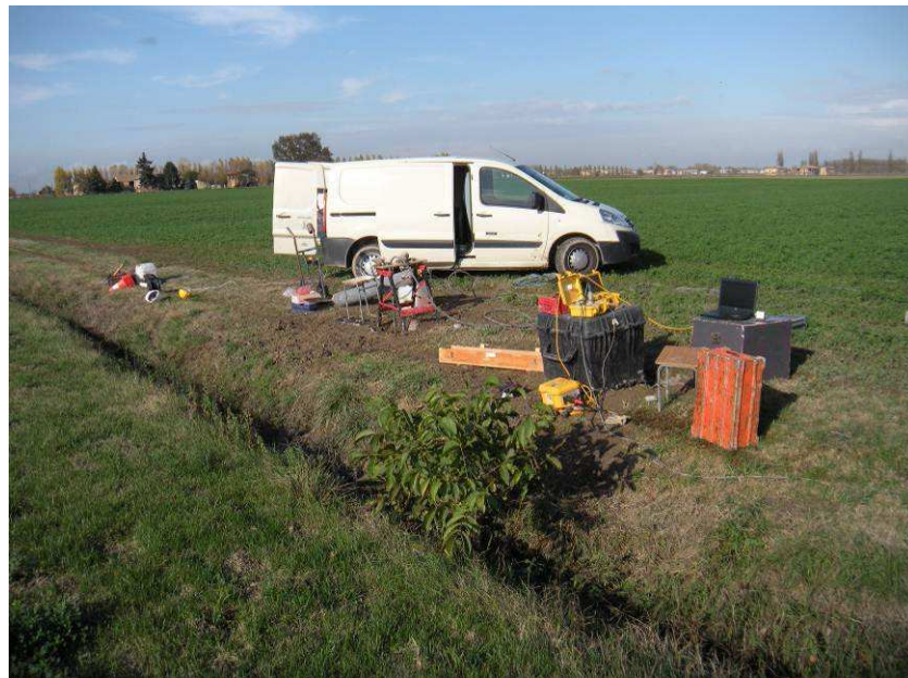
Figura 2.5 – Operazioni di acquisizione dati del carotaggio sismico CH eseguito sulla coppia di fori BH 606 e CH 606 (località S. Agostino).
