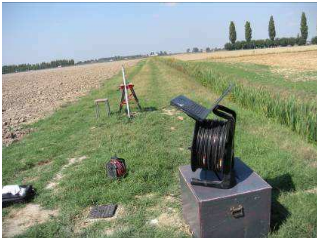
Figura 2.1 – Operazioni di acquisizione dati del carotaggio sismico CH eseguito sulla coppia di fori BH 407 e CH 407 (località Poggio Renatico).
