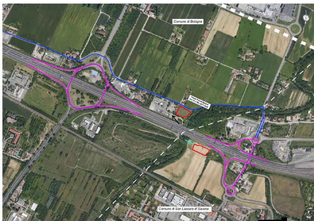
Fig.7 - Aree di cantiere (in rosso) e viabilità di accesso al cantiere del ponte Savena
