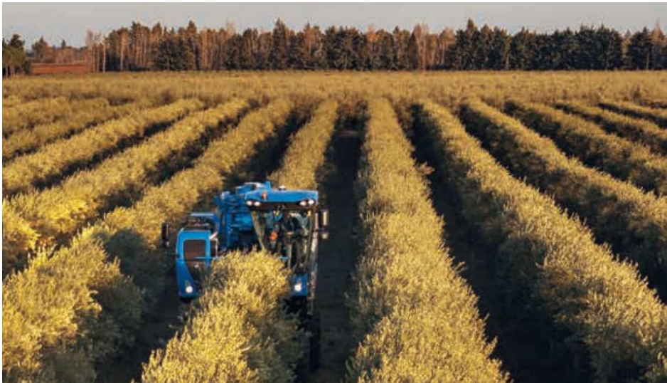
Figura 9: Raccolta meccanizzata con scavallatrice (foto dal sito web di New Holland www.newholland.com )
