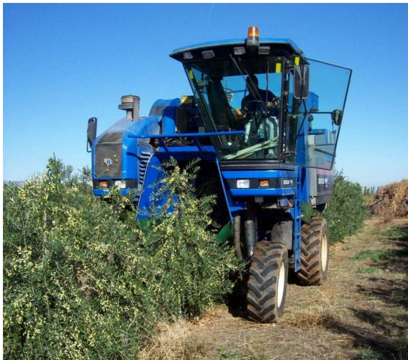
Figura 10: Raccolta meccanizzata con scavallatrice (foto dal web)
