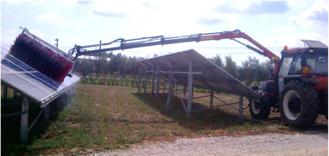
Figura 17: Immagine di macchina lava moduli ( http://www.morellimpianti.it/ ).
