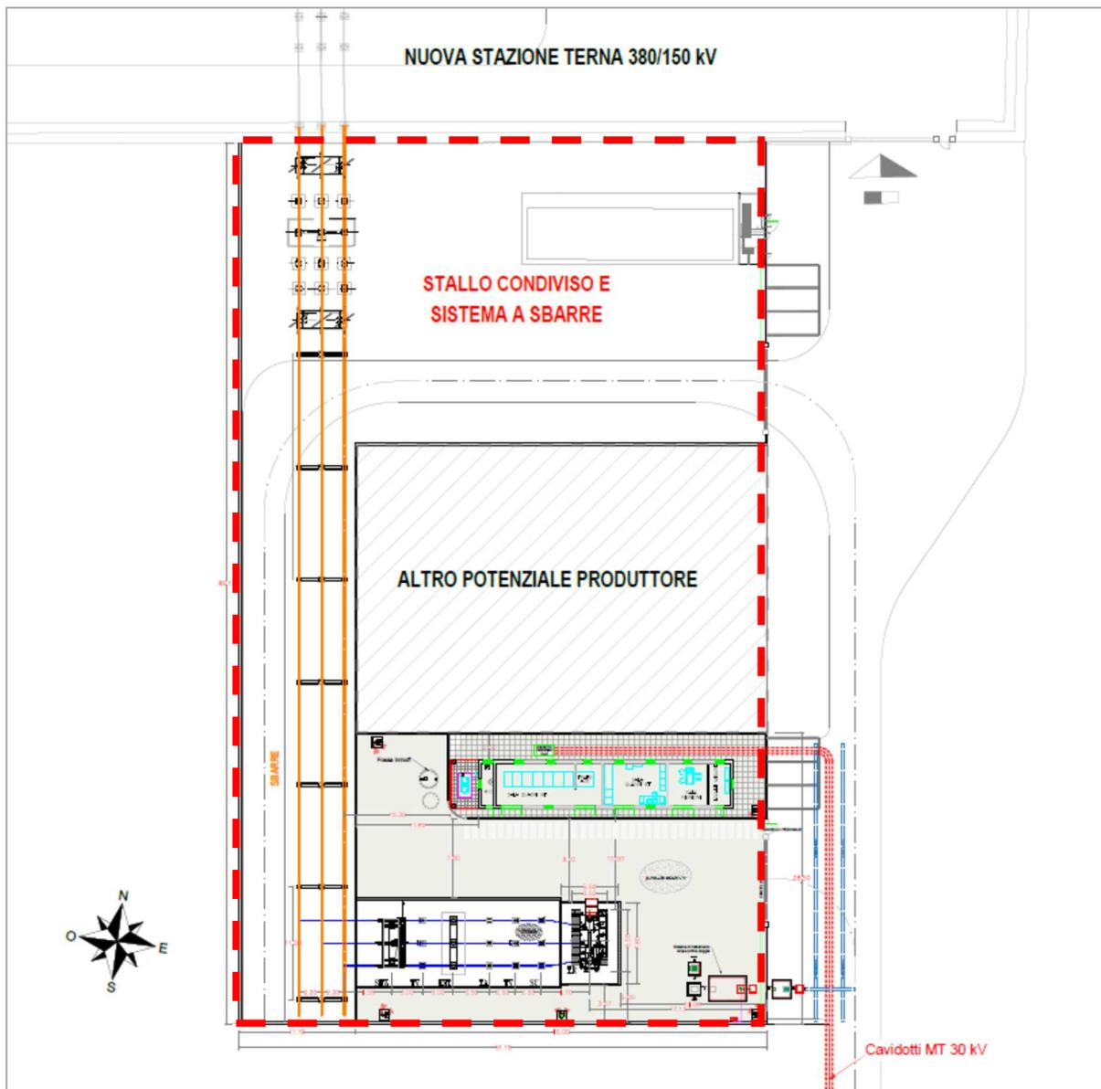
Figura 2\_planimetria Stazione di connessione
