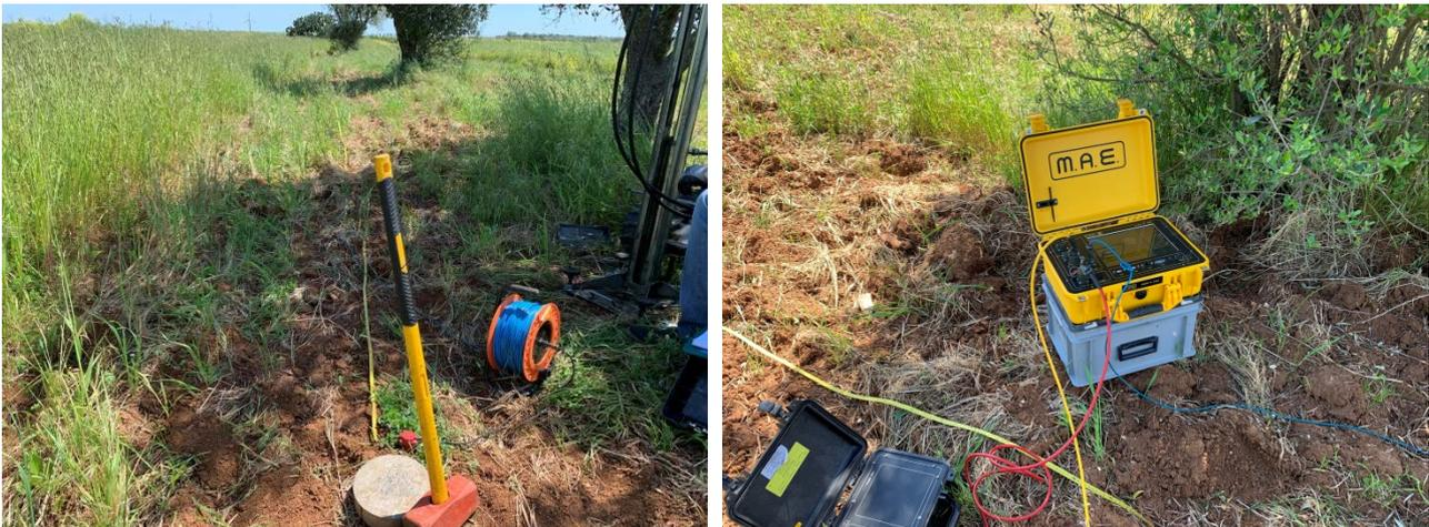
**Figura 39:** Fase di esecuzione indagine sismica a rifrazione all'interno dell'Area 1S.
