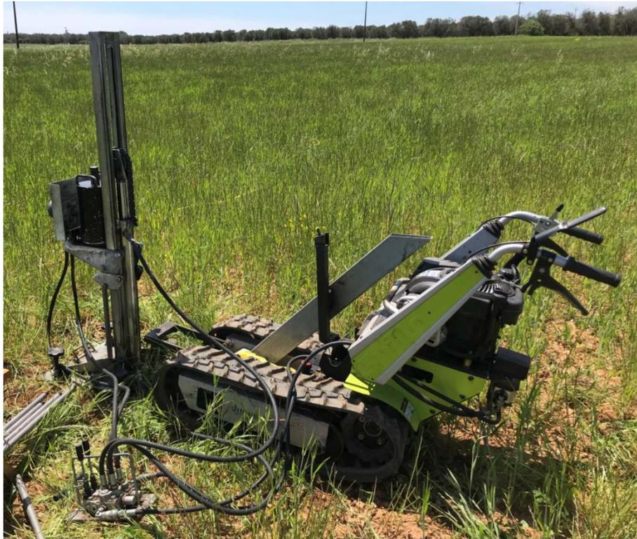
**Figura 25:** Penetrometro DM30SASX Dinamico Medio: fasi di esecuzione delle indagini.
