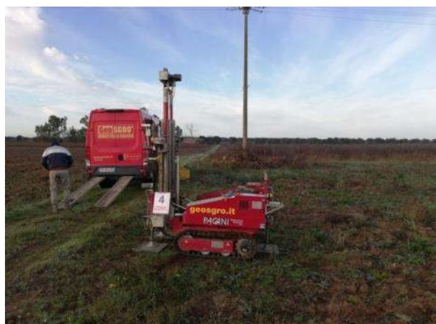
**Figura 20:** Penetrometro statico/dinamico TG 63-200KN – Pagani: fasi di esecuzione delle indagini.
