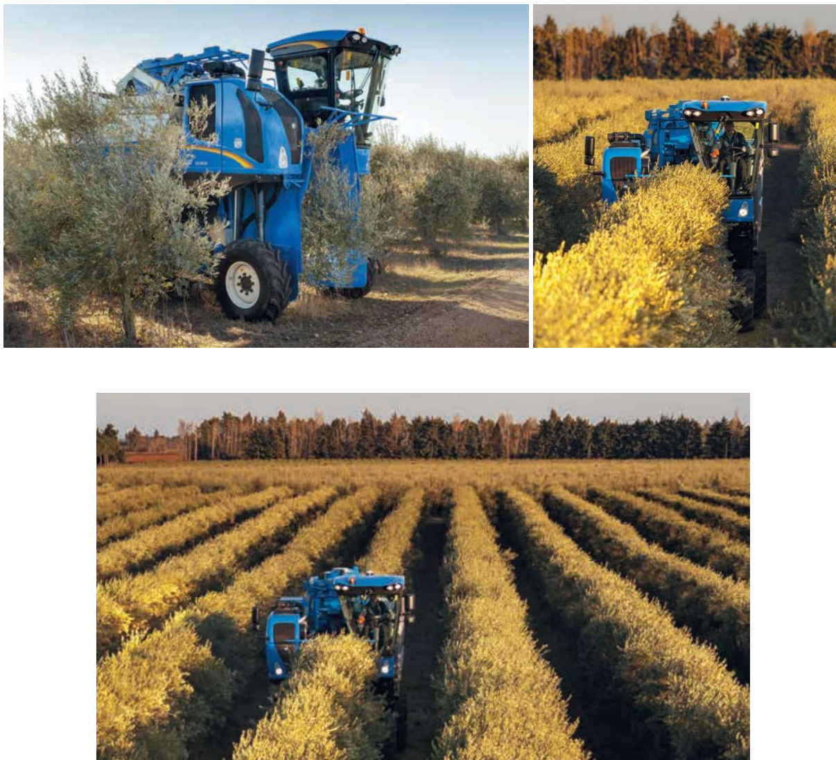
Figura 14: Raccolta meccanizzata con scavallatrice (foto dal sito web di New Holland www.newholland.com )
