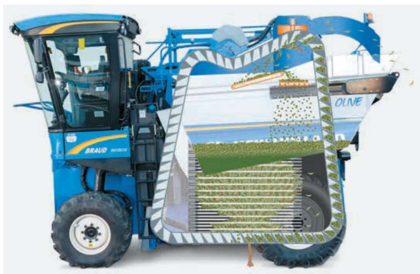
Figura 15: Sezione concettuale della scavallatrice (foto dal sito web di New Holland www.newholland.com )
