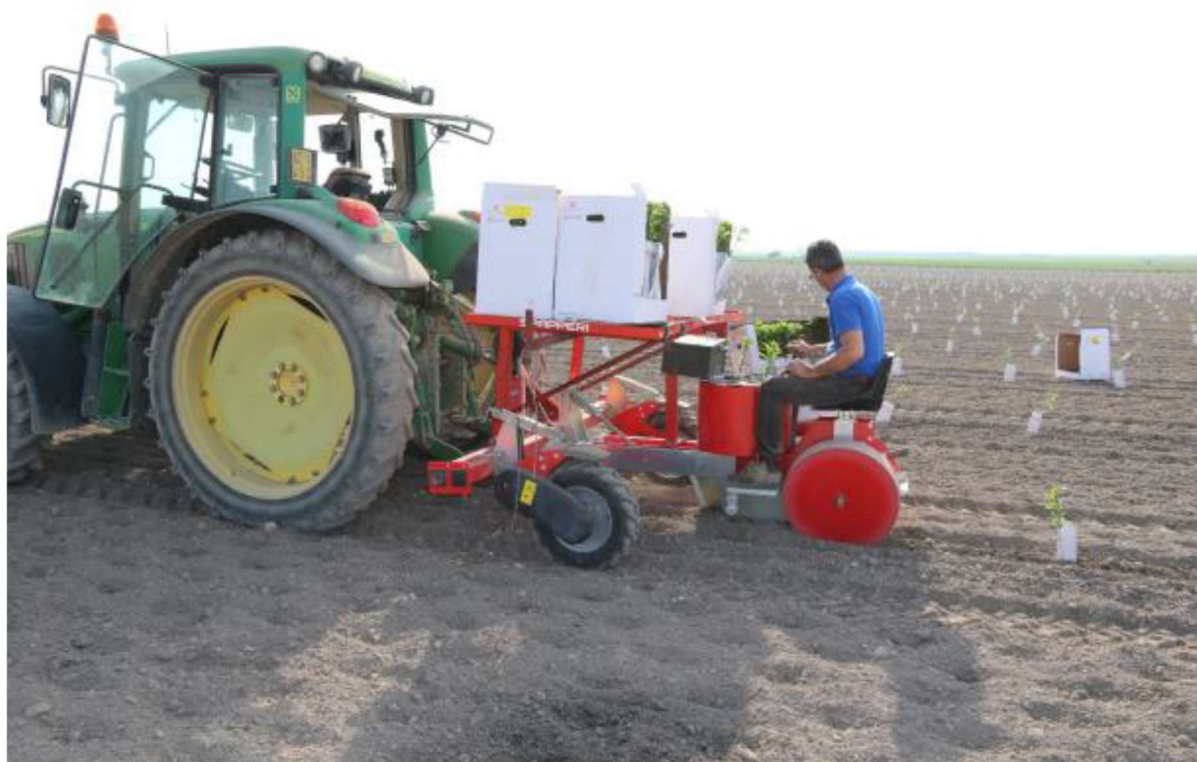
Figura 12: Messa a dimora meccanizzata (foto dal web)
