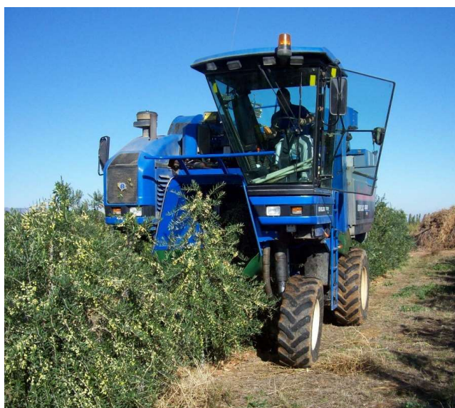
Figura 16: Raccolta meccanizzata con scavallatrice (foto dal web)
